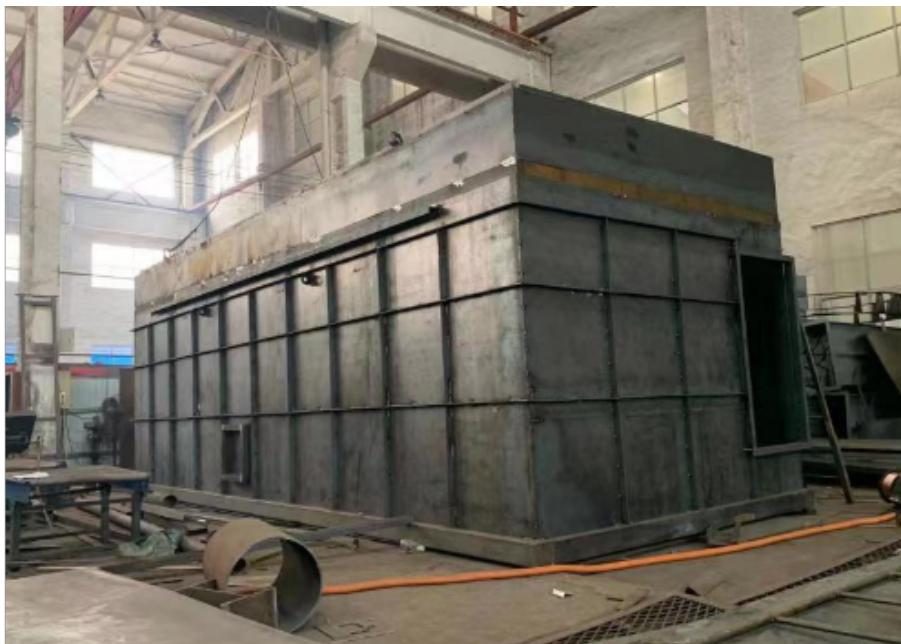
小型箱式脉冲喷吹除尘器。箱式喷吹是一个滤袋室用一个脉冲阀喷吹，不设喷吹管，一台除尘器分为若干个滤袋室，装设与袋室匹配的若干脉冲阀，箱式喷吹脉冲除尘器的较大优点是喷吹装置简单，换袋维修
