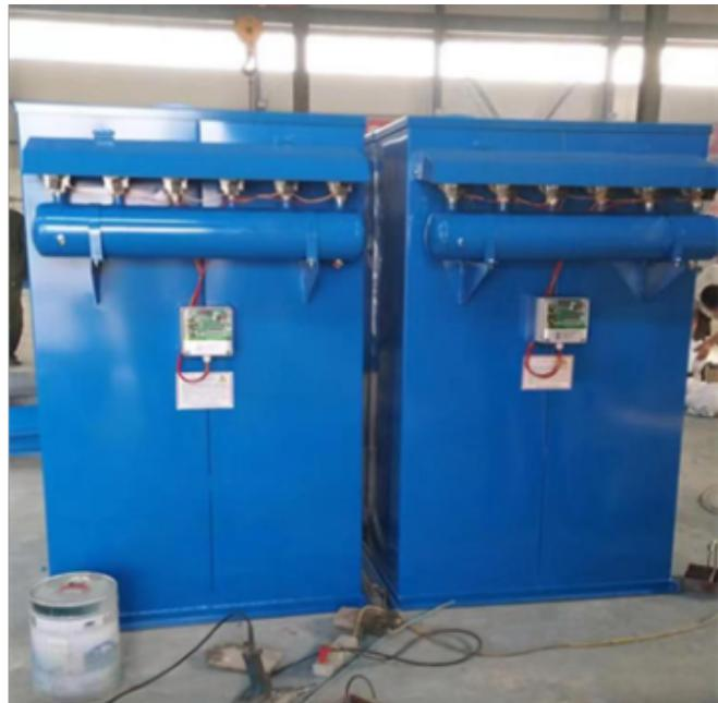
布袋除尘器主要由上部箱体、中部箱体、下部箱体（灰斗）、清灰系统和排灰机构等部分组成。布袋除尘器具有如下优点：1. 除尘效率高，可捕集粒径大于 $0.3\mu\text{m}$ 的细小粉尘，除尘效率可达99%以上。2. 适应性强，能处理不同类型的颗粒物，处理容量可大可小。3. 操作弹性大，入口气体含尘浓度变化较大时，对除尘效率影响不大。4. 结构简单，运行比较稳定，投资较少（与电除尘器比较而言），维护方便。所以布袋式除尘器广泛应用于消除粉尘污染，改善环境，回收物料等。
